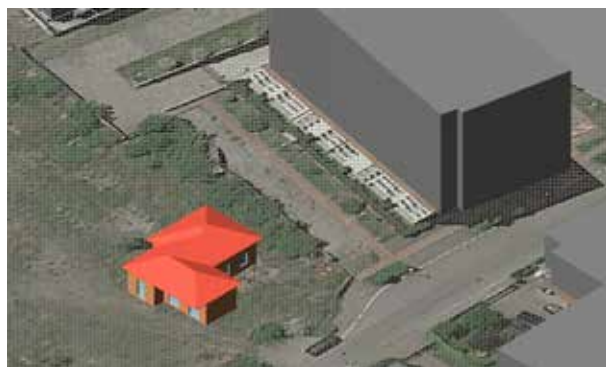
Figura 1: simulazione degli ombreggiamenti con software EDILCLIMA EC700.
