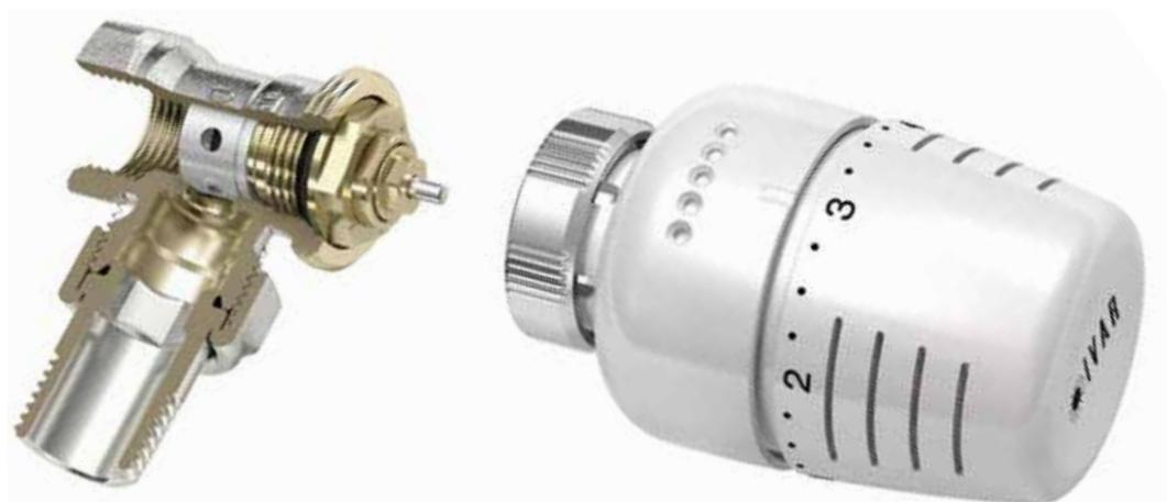
Le valvole termostatiche preregolabili presentano pertanto la possibilità di impostare direttamente sul corpo valvola un certo grado di preregolazione atto a “controllare”, secondo quanto voluto dal progettista, la portata massima in condizioni di progetto.
