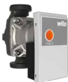
La **pompa a giri variabili** è particolarmente adatta perché adegua la propria prevalenza in funzione della condizione di esercizio dell'impianto, secondo una "regola" di portata-prevalenza impostabile dall'utente; nel caso di valvole termostatiche appare adatta una regolazione a prevalenza proporzionale.
