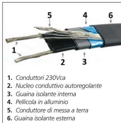
Figura n. 1: cavo autoregolante e descrizione costruttiva
