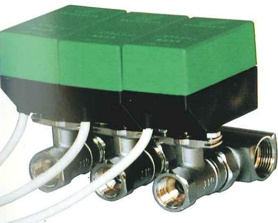
La MICRODIAM é una valvola a sfera motorizzata, con motoriduttore di dimensioni contenute, studiata appositamente per essere installata agevolmente nelle cassette di zona e montata sui collettori per la regolazione della temperatura dei locali asserviti ai pannelli radianti che a lei fanno capo.
