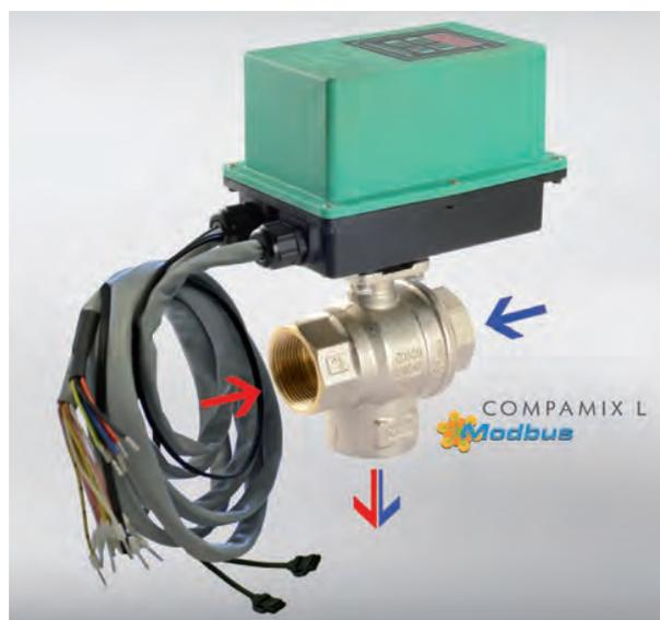
Sfruttando la porta seriale RS485 con protocollo di comunicazione Modbus-RTU è possibile mettere in collegamento la valvola miscelatrice con il PC. Attraverso il software **Comparato Legiotool**, si accede alle funzionalità, alle programmazioni e ai settaggi della valvola. Inoltre è possibile scaricare, visualizzare ed esportare in formato Excel i dati dei cicli antilegionella effettuati e memorizzati dalla valvola.
